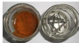
Korrosionstest nach 4 Wochen:
